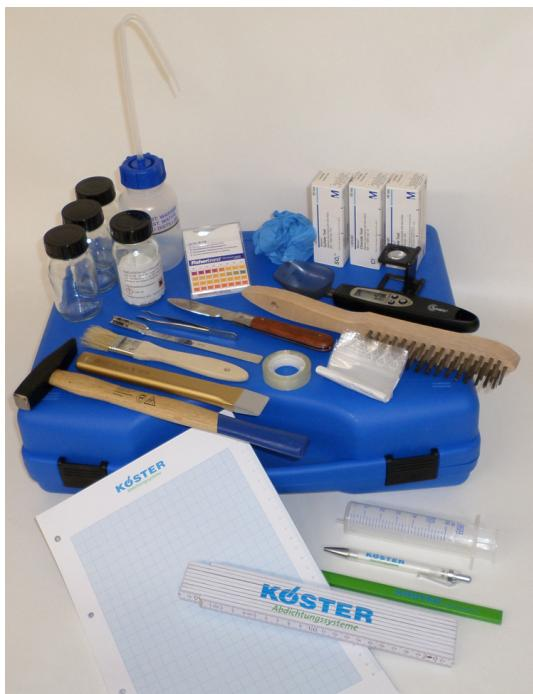
Osim pribora i alata (čekića, dlijeta, žičane četke, sklopivog metra, zidarske olovke, pincete, četke, dva para jednokratnih rukavica i malog povećala) u koferu se nalaze upute, blok za pisanje i olovka.
